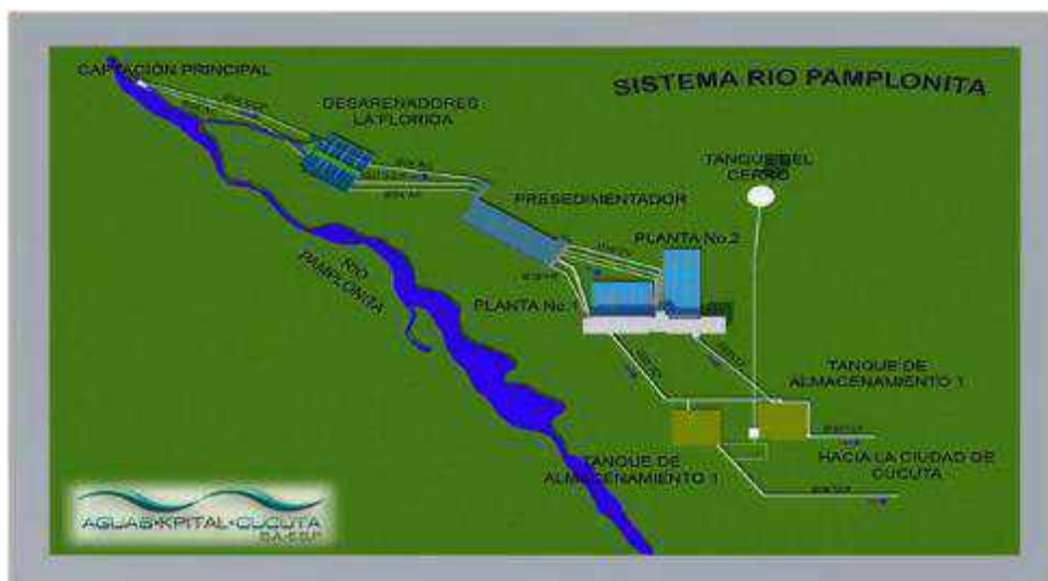
Imagen 005: Sistema de Acueducto Río Pamplonita
