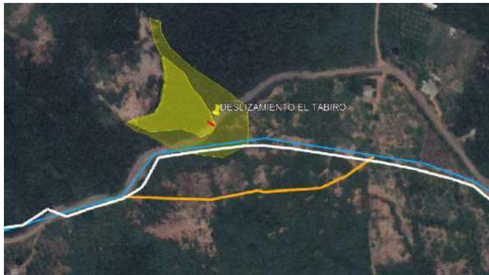
Figura No 9 Imagen relocalización tubería Ø39", Sector deslizamiento.
