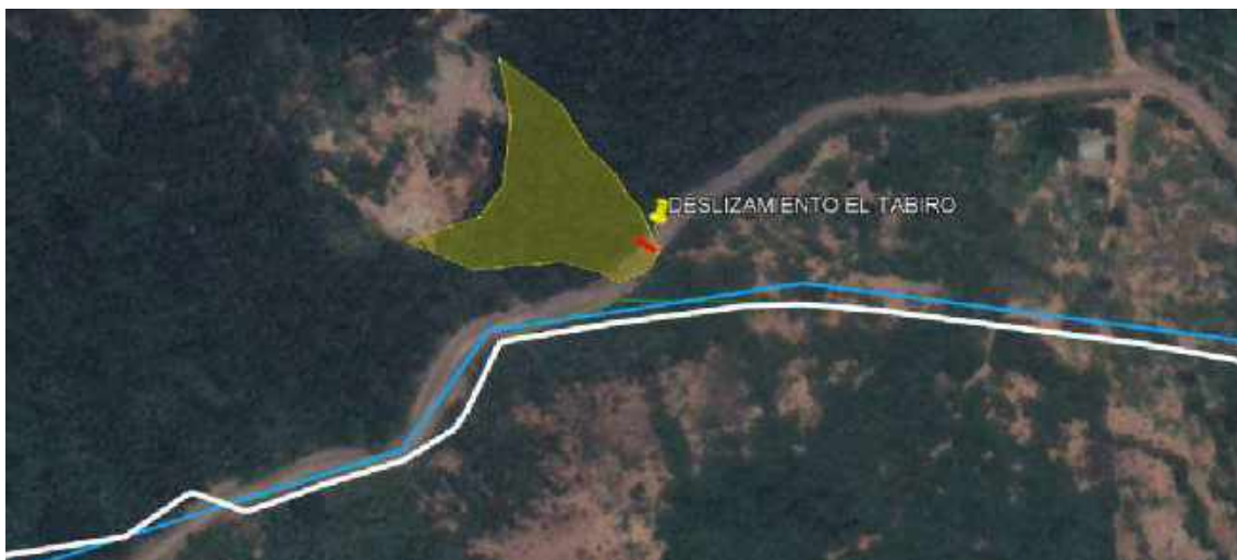
Figura No 2 Vista general del sitio del deslizamiento y trazado de tuberías existentes CCP Ø39 del subsistema Zulia Acueducto de Cúcuta (azul) y GRP Ø48” (blanca) del Acueducto Metropolitano
