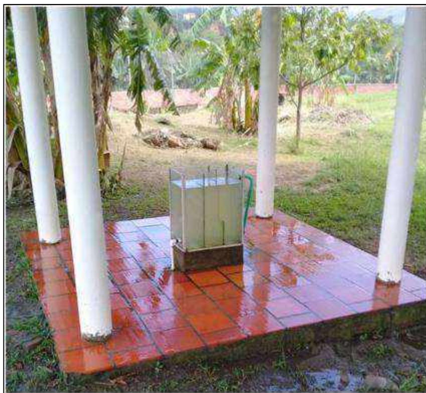
Imagen 036: Sistema Bioalarma Pamplonita Tanque Desarenador ubicado en el Corregimiento San Pedro
